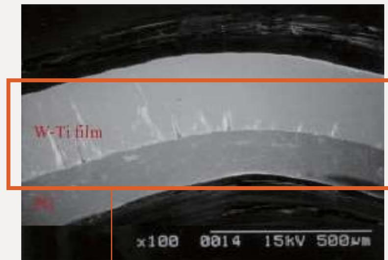
付着膜の収縮に追従して変形する。
